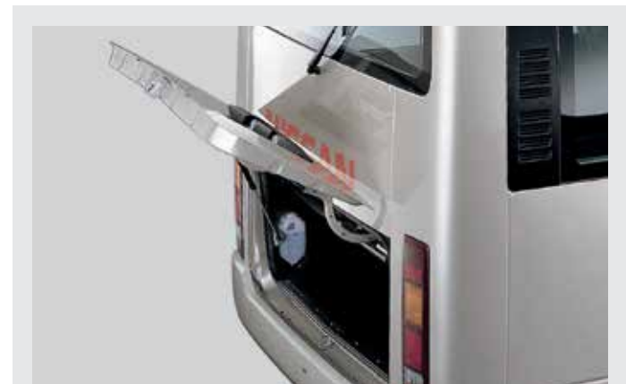
Le compartiment à bagages possède une lampe intérieure et un volet à large ouverture.
